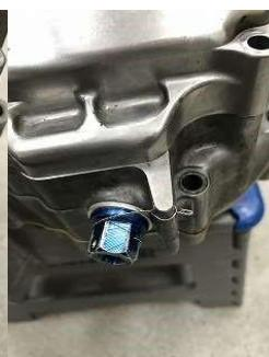
ドレンボルトにワイヤーを通し、固定する部分に沿わせ適当な長さでワイヤーを切れます。(少し長めに)
